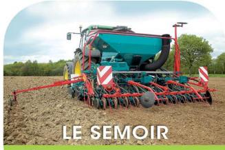
Il creuse le sol en formant des sillons et y sème des graines. Il recouvre le tout de terre.
